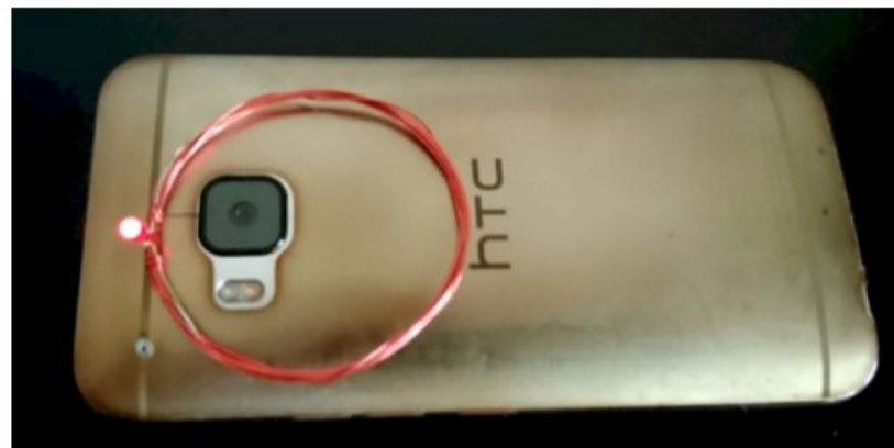
Abb. 3 Nachweis des NFC-Feldes mit einfacher Antenne und LED
