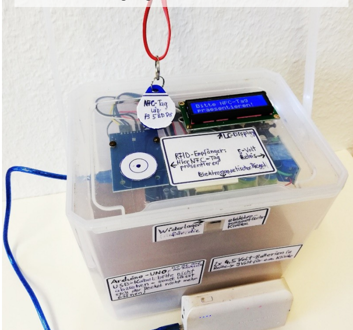
Powerbank für die Stromversorgung: Diese könnte auch über ein Netzgerät oder einen Rechner erfolgen.
